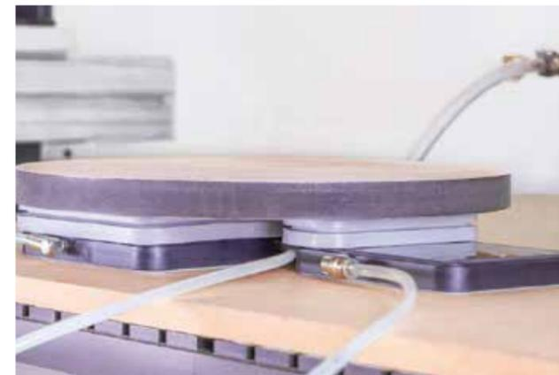
Les blocs de bridage par le vide VCBL-G K1 peuvent être placés directement sur la plaque d'usure de la machine.
