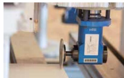
Fraisage P-System à l'aide de la Zeta P2 ou de la machine CNC
