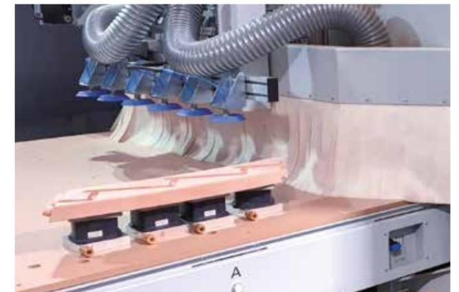
Grâce à la plaque d'adaptation AP-G, il est également possible d'utiliser des blocs de bridage par le vide VCBL-B sur des machines de Nesting.
