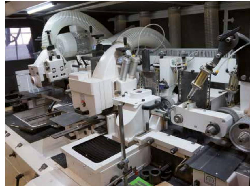
La nouvelle corroyeuse 4 faces HOMAG avec arbre de profilage de l'intérieur
