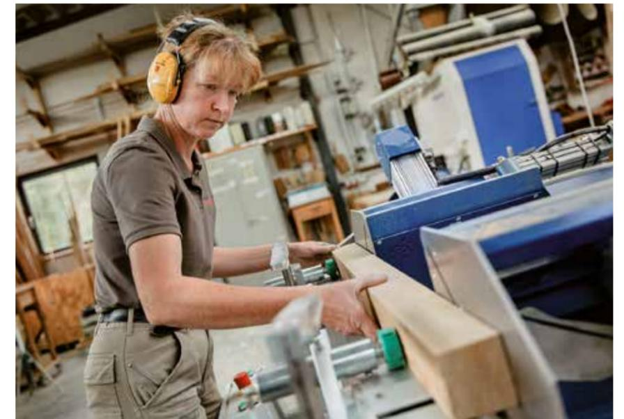
**De manière standard, la menuiserie Vielstädte découpe ses profils et baguettes jusqu'à une longueur de 3000 mm sur sa nouvelle «Exenso DS», alors que les pièces au-delà de 3000 mm sont commandées et découpées grâce au logiciel automatique Hecht.**
